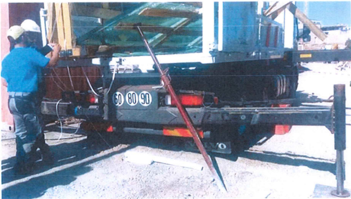
Photo 3 = Plateau du camion stabilisé, penchant sur le côté
