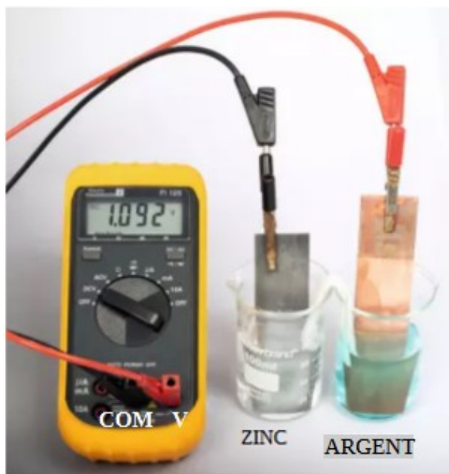
Affichage du voltmètre une fois le branchement effectué.
